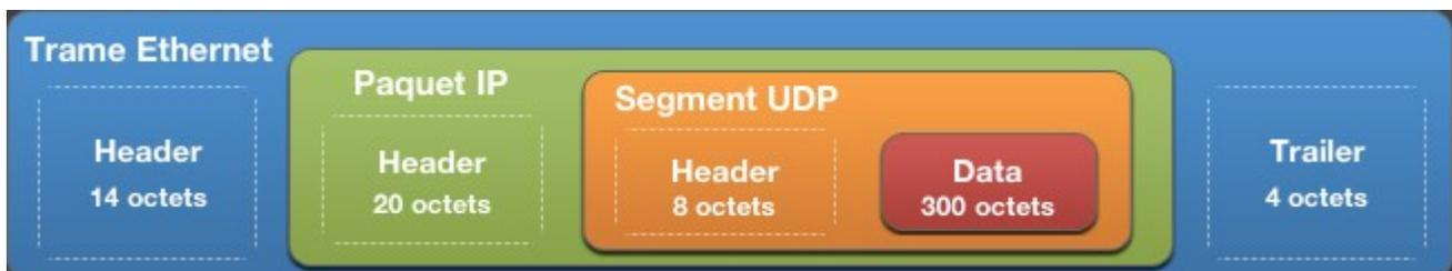
*Fig. 4: Encapsulation des données*
